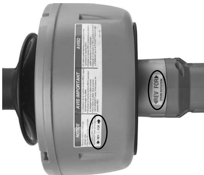
Obrázok 5 – Štítky FOR/REV (Dopredu/Dozadu)
