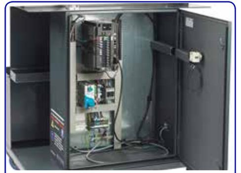
Abgedichteter Schaltkasten mit allen numerisch gesteuerten Kontrollen und aller Verkabelung
