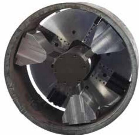
Innovative breite Verriegelungskiefer bieten Verriegelung auf sechs Punkten mittels drei Kiefer, was eine hervorragende Klemmleistung gewährleistet für ratterfreie Anfasungen.
