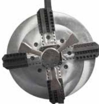
Eine selbstzentrierende Verriegelungswelle aus einem Stück von 70 mm mit eingebauten Kiefern macht kurzen Prozess mit dem Problem gebrochener oder sich lösender Rückholfedern und O-Ringe.
