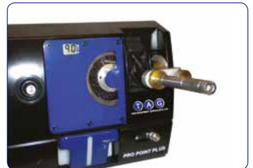
Halter kann einfach positioniert werden, um Spitze bei 90° zu ebnet
