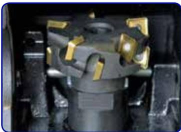
Fräskopf aus einem Stück, mit zehn mit Schrauben befestigten Wendeschneidplatten
