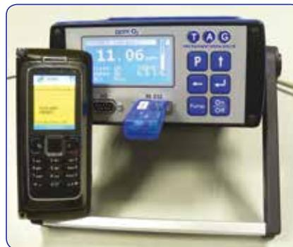
Verbunden mit einem Bluetooth-Dongle mit einem Bereich von bis zu 100 m zum Handy. Via das Handy können alle relevanten Daten, worunter den Restsauerstoffgehalt und die Sensortemperatur aufgezeigt werden. Mit einfachen Aufträgen kann der Pro Purge 1 von Abstand bedient werden
