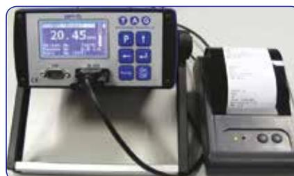
Verbindung des Monitors mit einem Drucker via die RS-232-Schnittstelle. Imstande, abgelesene Dokumentation (pro Sekunde) zum Drucker zu senden
