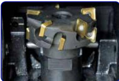
Fräskopf aus einem Stück, mit zehn mit Schrauben befestigten Wendeschneidplatten.
