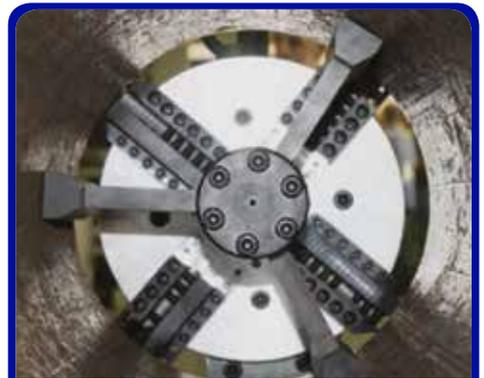
Innovative breite Verriegelungskiefer bieten Verriegelung auf sechs Punkten mittels drei Kiefer, was eine hervorragende Klemmleistung gewährleistet für ratterfreie Anfasungen.
