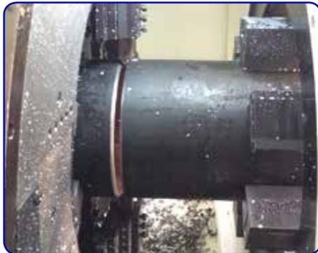
Zweifaches hydraulisches Klemmsystem: Vorder- und Rückseite des Schnitts
