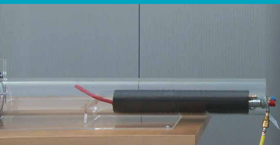
Test vzduchem podle EN 1610
