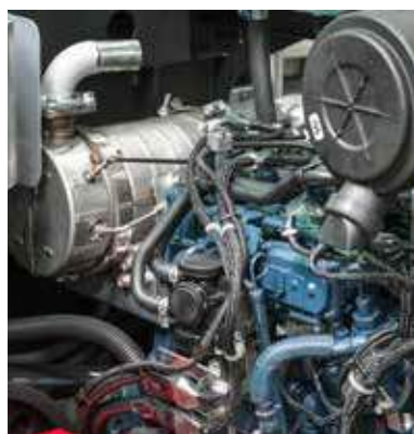
Tier 4/Stage V Dízel motor beépített részecskeszűrővel és katalizátorral
