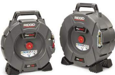
Stroje RIDGID® FlexShaft využívají specializované řetězové omílače připojené k ohebnému tlačnému nástroji, který se otáčí při vysokých rychlostech pomocí akumulátorové vrtačky s nastavitelnou spojkou (není součástí dodávky) připojené ke středové hnací hřídeli. Vzhledem k tomu, že se hřidel otáčí uvnitř odolného nylonového pláště, který je umístěn v plně uzavřeném bubnu, vzniká méně nepořádku na pracovišti.
