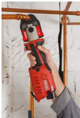
Otevřete lisovací čelist a stejnou rukou stlačte spoušť, čímž šetříte čas a námahu!
