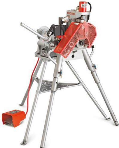
Válcovačka obvodových drážek RIDGID® model 920 přivedla drážkování na úplně novou úroveň. S pracovním rozsahem trubek o průměru 2" - 24" má toto zařízení nejvyšší kapacitu ze všech válcovaček obvodových drážek RIDGID®. Model 920 se montuje na strojní pohon RIDGID® model 300 pro použití na stavbě i v dílně. Dodává se též podpěra na roury s velkým průměrem, model RJ-624, pro drážkování trubek do průměru 24", což je perfektní doplněk pro válcovačku obvodových drážek model 920 (viz str. 2.5).
