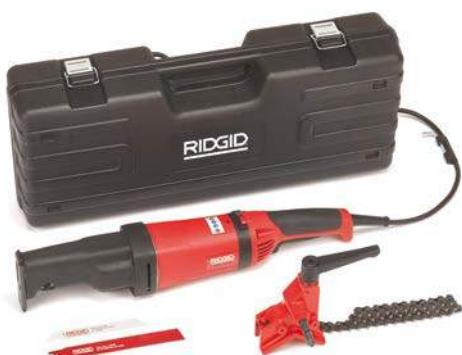
Přímočará pila RIDGID RS-570 pro silné zatížení je novým výkonovým standardem pro rychlé a snadné řezání ocelových trubek až do 6". Díky výkonnému 1300 W motoru a rychlému agresivnímu orbitálnímu pohybu, zajišťuje dokonalý řez nejen na ocelových trubkách, ale i na jiných aplikacích, jako jsou plasty, dřevo (i s hřebíky), cihly, ocelový plech, měděná trubka, beton, sádrokarton a mnoho dalšího.
