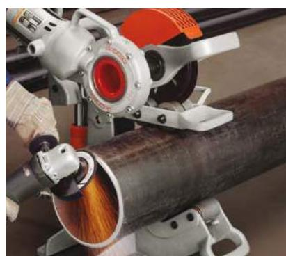
RIDGID Model 258 s otáčecím zařízením RIDGID Pipe Roller při použití na úkosování trubek. Pro tuto práci se doporučuje práce ve dvojici
