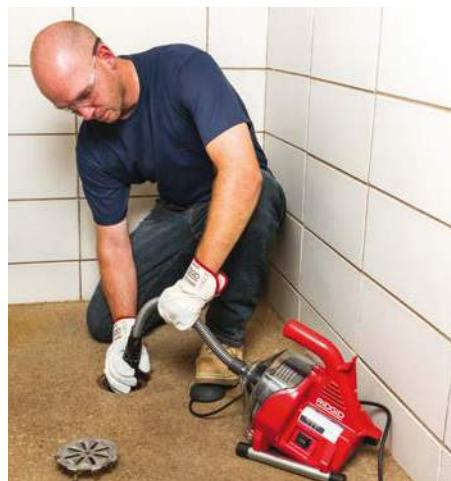
Výkonná, kompaktní a univerzální čistička odpadů PowerClear™ snadno vyčistí vany, sprchy nebo dřezy o průměru  $\frac{3}{4}$ " (20 mm) až  $1\frac{1}{2}$ " (40 mm).
