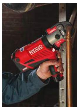
Čelisti kompaktní řady na trubky z mědi, oceli, nerezu, PEX a vícevrstvé trubky.
