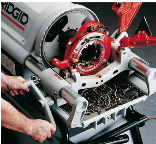
Závitořezná hlava, model 714 (914) s nastavitelným provedením.
