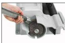
Volitelný odhrotovací kotouč se používá k odstranění vnějšího otřepu pro pomoc s těsnými tvarovkami
