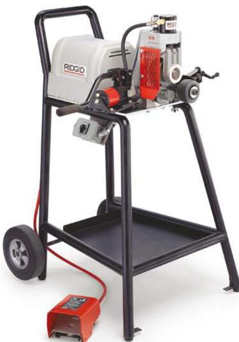
Válcovačka obvodových drážek RIDGID® model 918-I je schopná vytvořit drážky u trubek 1" až 8" ř. 40 a 1" až 12" ř. 10 rychleji než jakékoli jiné drážkovací zařízení této třídy. Model 918-I je poháněn univerzálním motorem 0,9 kW s převody pro velké zatížení a proto vytváří vysoko kvalitní drážky konzistentně a bez námahy.
