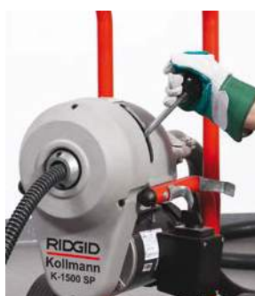
Zatažení páky spojky roztočí spirálu
