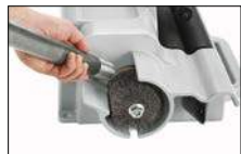
Volitelný odhrotovací kotouč se používá k odstranění vnějšího otřepu pro pomoc s těsnými tvarovkami
