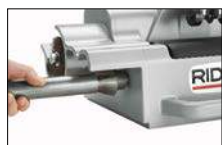
Vnitřní odhrotovač odstraní bez námahy otřepy, které by způsobily turbulentní proudění v potrubí
