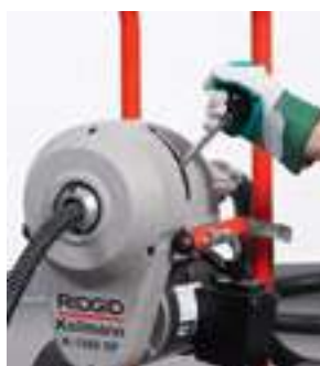
Zatažení páky spojky roztočí spirálu
