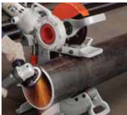
RIDGID Model 258 s otáčecím zařízením RIDGID Pipe Roller při použití na ukosování trubek. Pro tuto práci se doporučuje práce ve dvojici
