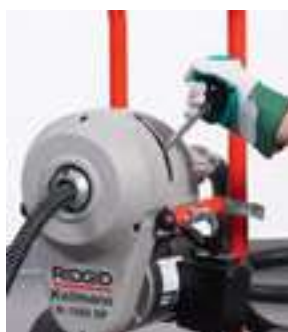
Zatažení páky spojky roztočí spirálu
