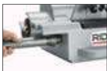
Vnitřní odhrotač odstraní bez námahy otřepy, které by způsobily turbulentní proudění v potrubí
