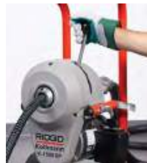
Engedje el a fogantyút, a kábel azonnal leáll
