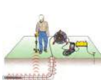
Keresse meg a műanyag csövet az integrált vezeték nyomkövetéssel.
