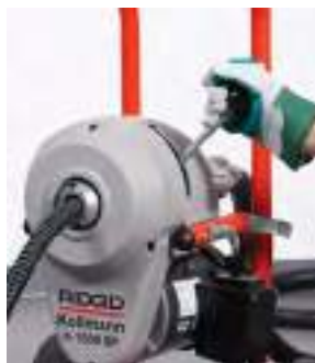
Kapcsolja be a kuplungot, a kábel forog
