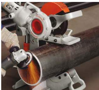
Modell 258 im Einsatz mit der Rohrrolle zum Anfasen. Diese Anwendung sollte von zwei Personen durchgeführt werden
