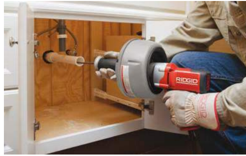
Modell K-45AF befreit blockierte Leitungen schnell. Spirale, ohne Umkehren der Laufrichtung des Motors, vorschieben und einziehen.
