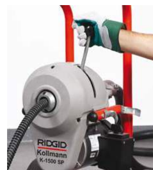
Wird der Griff losgelassen, kommt die Spirale sofort zum Stillstand
