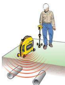
Induzieren eines Signals zur Lokalisierung von Versorgungsleitungen.
