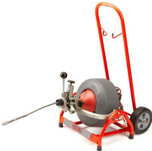
Das optionale Fahrgestell für den einfachen Transport der K-3800 zum Einsatzort
