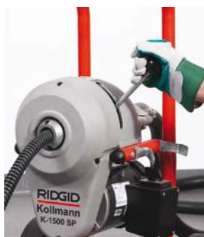
Wenn die Kupplung greift, rotiert die Spirale
