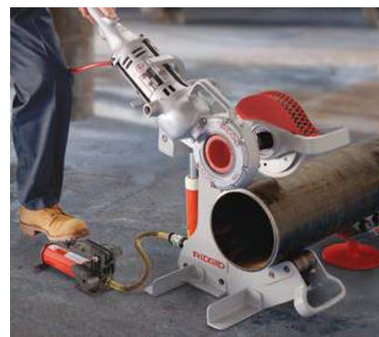
Elektro-Rohrabschneider Modell 258 mit Kraftantrieb Modell 700 beim Schneiden
