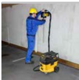
Certifikovaný vysavač a odsávač prachu k zachytávání zdraví ohrožujícího prachu dle EN 60335-2-69.
