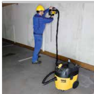
Bevizsgált porszívó, porelszívó az egészséget károsító porok elfogására EN 60335-2-69 norma szerint.
