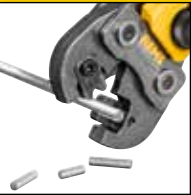
Darabolófogók 1 pár megfordítható darabolóbetéttel acélhoz, rozsdamentes acél, M 6 – M 12, 4.8 (400 N/mm²) szilárdsági osztályig.
