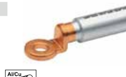
Lisovacie káblové oká Al podľa 46329 16 - 500 mm²
