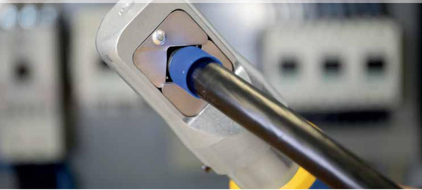
EK 30 ID ML Akumulátorový hydraulický krimpovací nástroj
