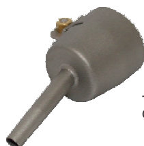
Speciální tažná tryska Ø 3mm pro vysoce fluorizované umělé hmoty se závitem M14 (např. PFA, ECTFE) Obj. č. 5201017
