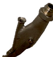
Rychlosvařovací tryska profil závit M14 se stehovacím zobáčkem ▽ 5,7 x 3,7 mm Obj. č. 5113670 ▽ 7 x 5 mm Obj. č. 5113671
