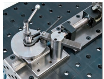
Hakenbiegen aus Rundmaterial
