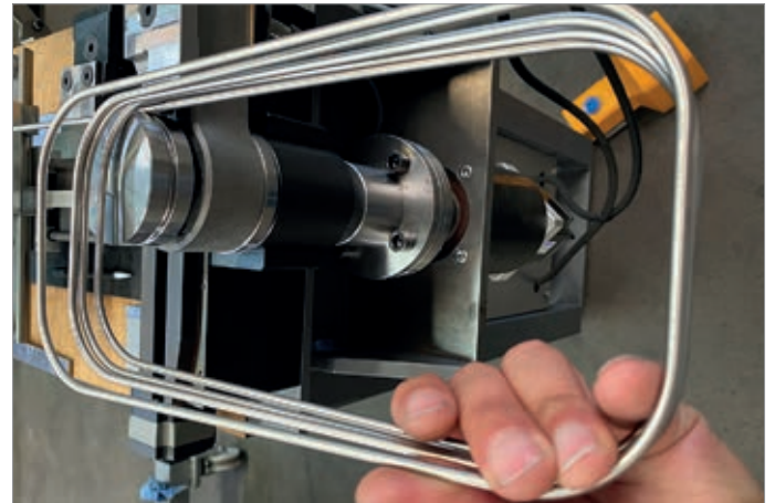
4 mm Draht Spiralbiegen
