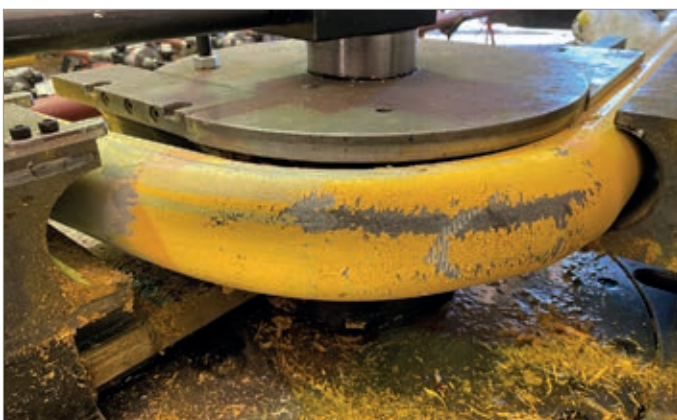
Biegen von lackierten Fernwärmerohren
