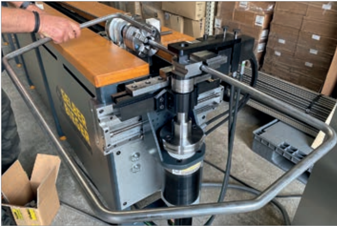
18 mm Stahlrohrrahmen geschlossen
