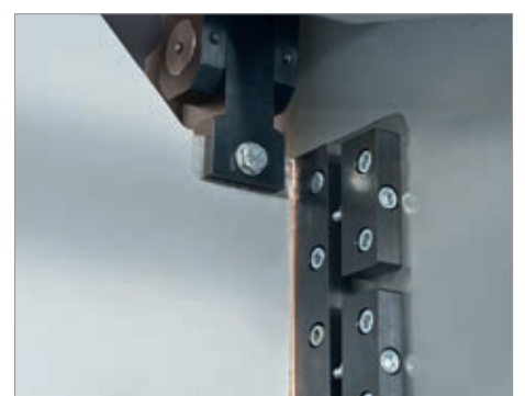
Einfache nachstellbare Führung
