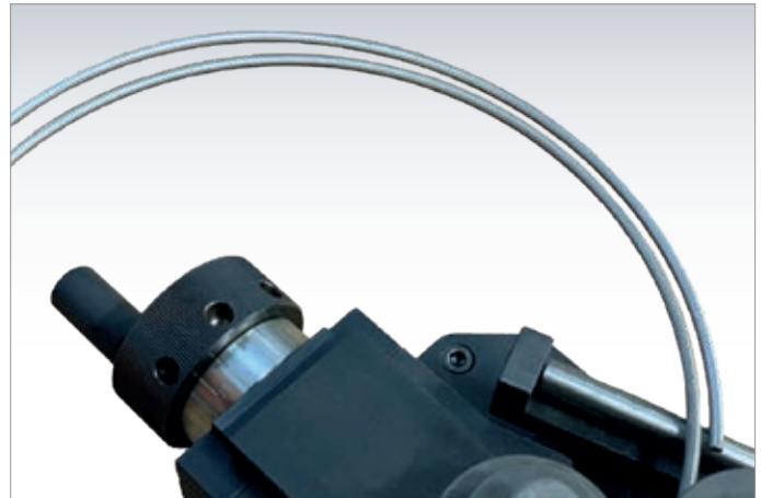
4 mm Rundbiegen zu einem Ring
