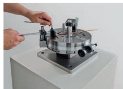
Einstellung für kurze Teile
