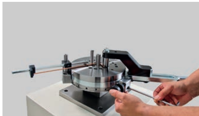
Winkelanschlag beliebig zu befestigen
