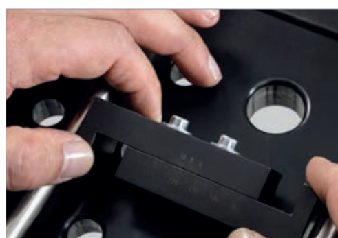
Einsetzen der Abstandslehre
