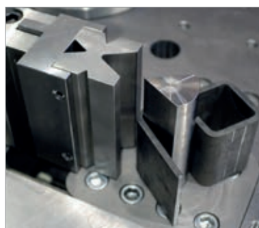
Biegedorn für enges Biegen
