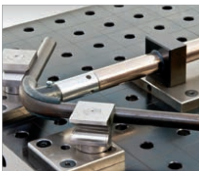
Rohrbiegen durch Drücken
