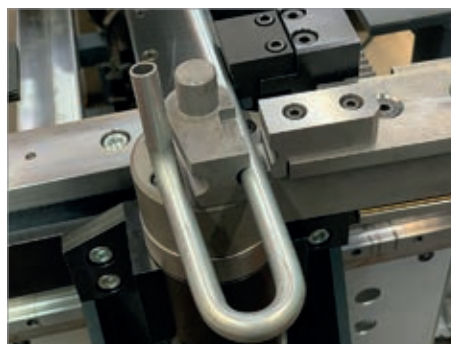
Biegen mit Booster 1,2 x D
