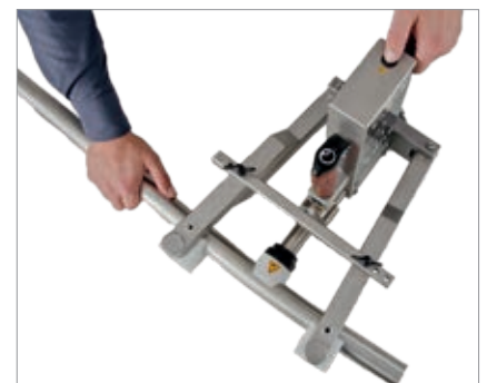
Biegen von Rohr 42 mm
