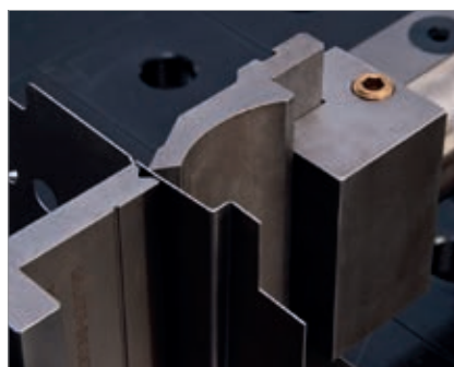
Biegen mit Stempeladapter und T - Matrize
