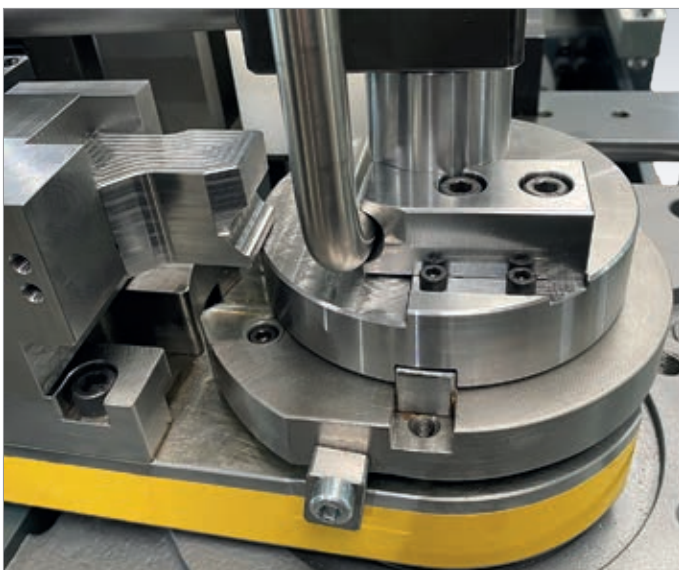
Biegen von Vollmaterial \varnothing 16 mm Radius 22 mm
