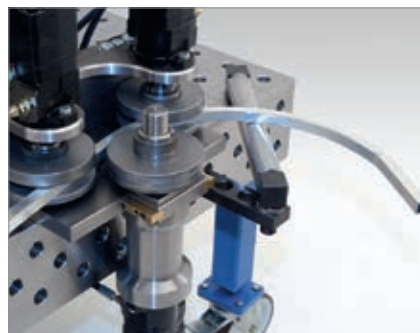
Biegen von Alu 25 x 25 mm Rohr
