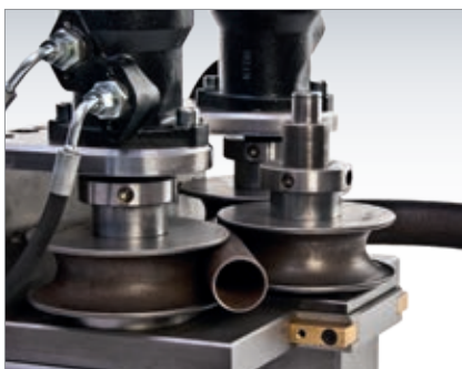
Biegeleistung bis Rohrdurchmesser 48 mm
