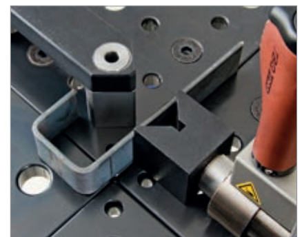
Kanten von Flacheisen 60x8 mm
