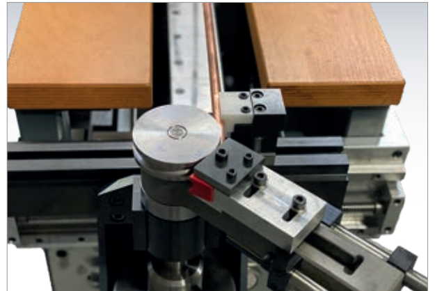
Kupferbiegen mit Gleitschuhtechnik
