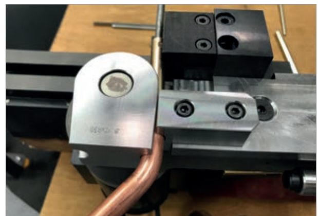
Kupferrohrbiegen mit Dorn
