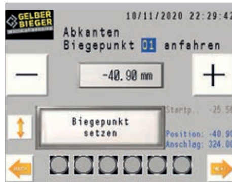
Anfahren des Biegepunktes mit + Taste
