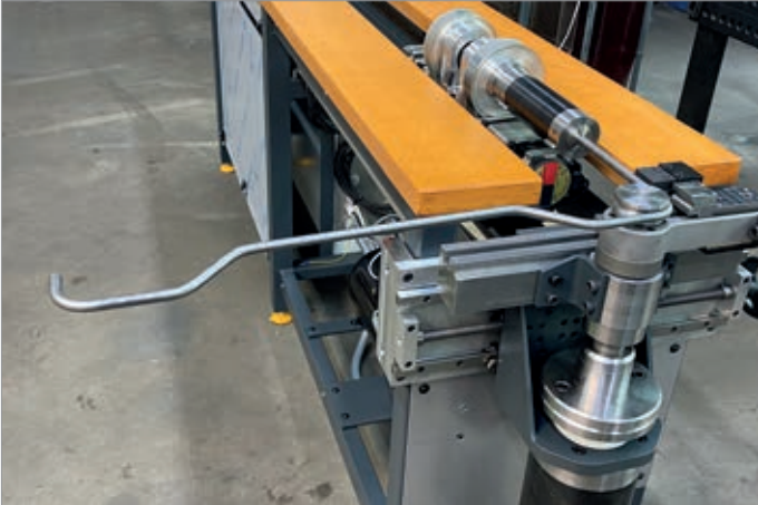
Beispiel ERB 16 Rohr 12mm
