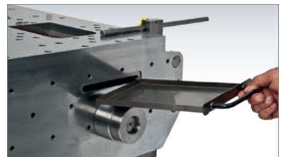
Schublade zum Auffangen von Zunder
