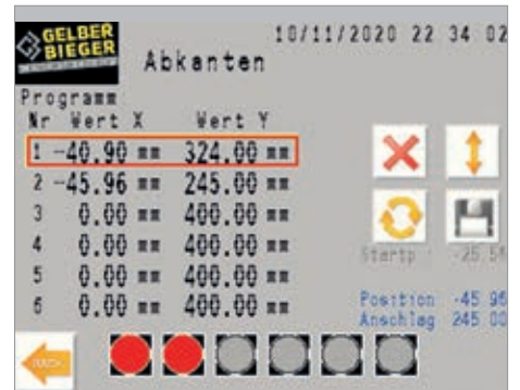
Fertiges Programm mit Hub und Anschlagwert
