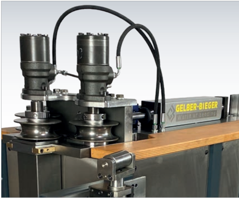
Vario III hydraulische Zustellung und drei angetriebene Walzen
