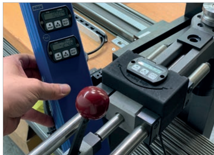
3 Digitalanzeigen / Länge, Verdrehung, Winkel
