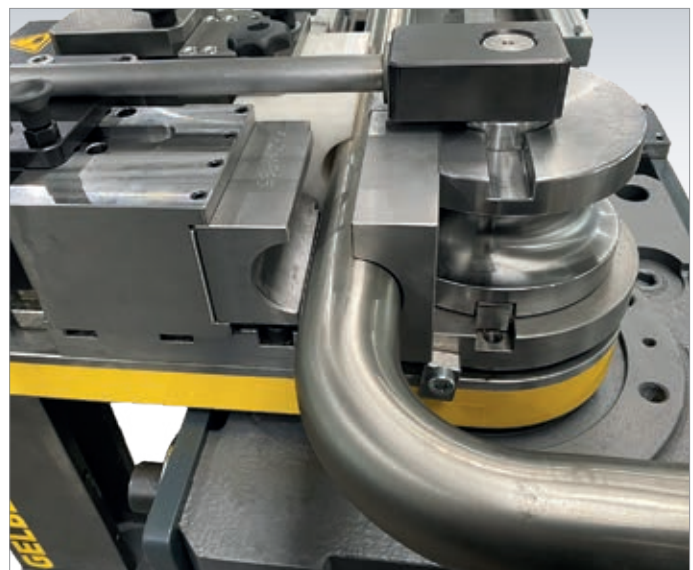
Biegen von Rohr \varnothing 42,4 \times 2 mm mit Radius 65 mm
