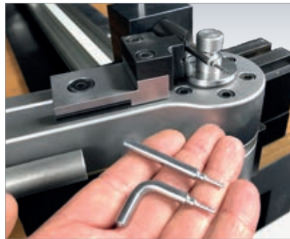
kurze Schenkel biegen
