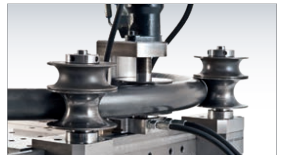
RB 40 Plus mit 76 mm Rohr
