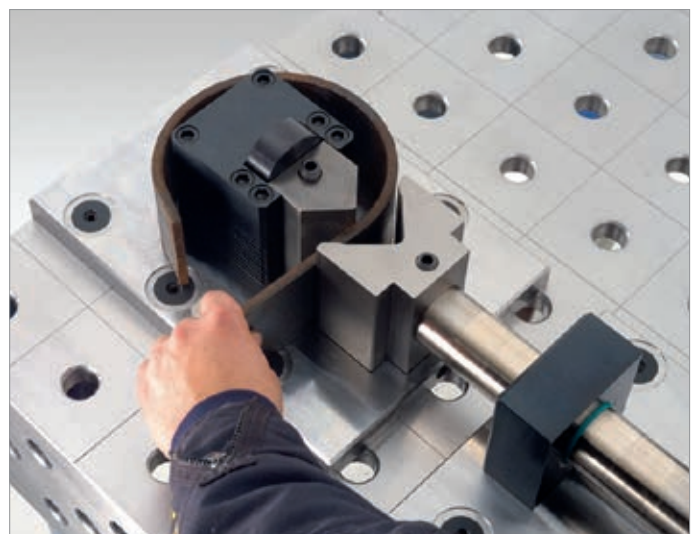
für geschlossene Teile; Matrize drückt in Stempel
