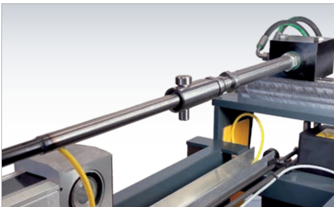
Dornstangenrückzug mit Einstellung
