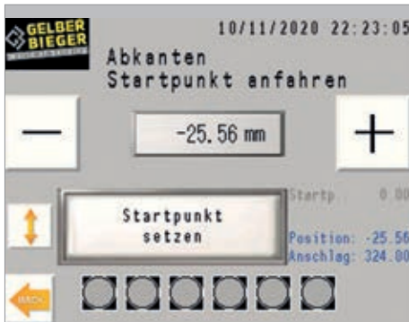
Anfahren des Startpunktes mit + Taste
