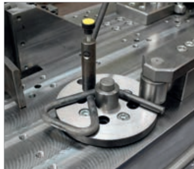
Drehteller zum Aufwickeln
