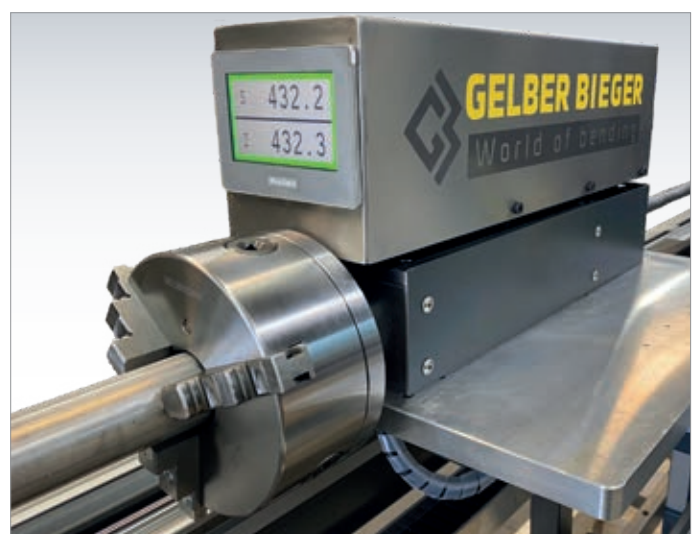
Die Anzeige springt auf Grün bei Erreichen der Sollposition
