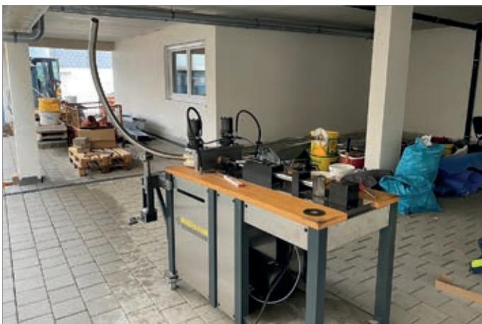
Wendelbogen auf Baustelle
