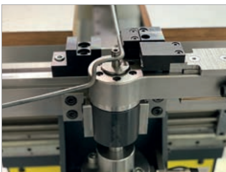
Drahtbiegen im Uhrzeigersinn
