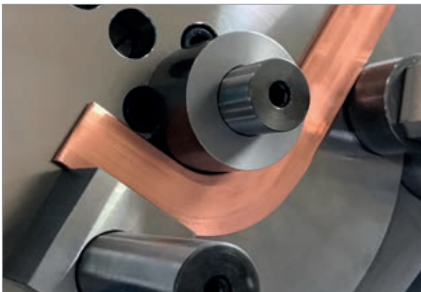
Flacheisen auf Kante 30 x 6mm
