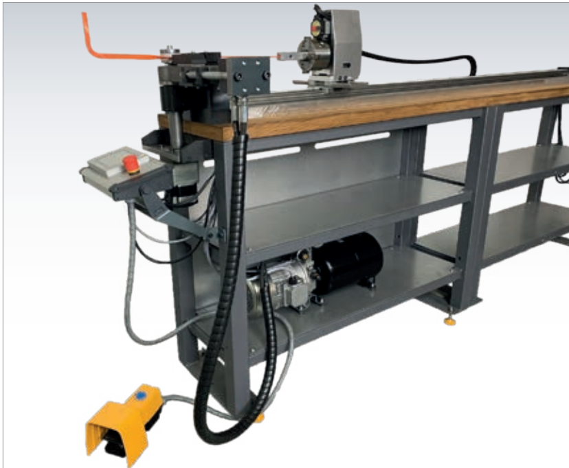
HRB 16 NC 2, gesteuerte Variante mit Antrieb und hydraulischen Spannen
