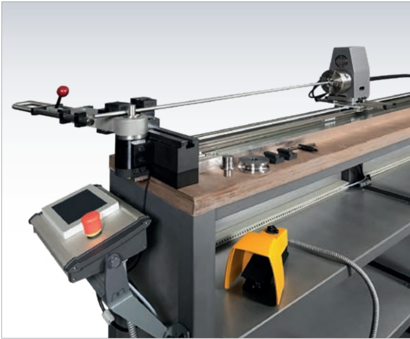
HRB 16 NC 2 2000 mit Spannhebel im Biegearm
