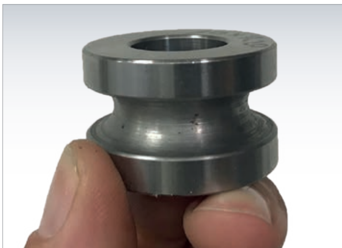
Biegewerkzeug ohne Spannfläche
