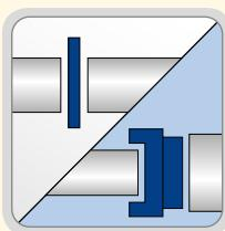
zařízení **svařuje čelně** v rozsahu ø 40 – 160 mm
