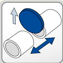
odtrhávač svařovacího zrcadla usnadňuje jeho oddělení od svařovaných ploch po dokončení fáze nahřívání (pouze u STH 500 a 630)
