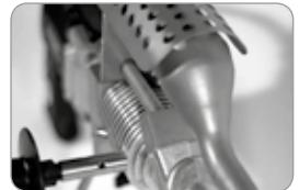
Pro spojování desek a fólií nabízíme osvědčený univerzální extruder typu ES 2. Lze jím svařovat všechny desky a fólie u nichž výrobce svařování jako metodu spojování doporučuje. Rozsah jejich dimenzí je velmi široký, mimo jiné i díky několika nabízeným tvarům svařovacích botek. Pro specifické potřeby zákazníka dodáváme polotovar svařovací botky, určený k vlastnímu obrobení, nebo jej obrobíme podle dodané dokumentace.
