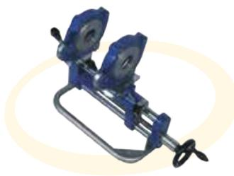
Mechanické zařízení, které umožňuje čelně svařovat potrubí do Ø 110 mm pod úhlem 0° – 30°. Je vybaveno vložkami, které umožňují svařování dlouhých úseků trubek i speciálních tvarovek. Zařízení je vybaveno elektrickým svařovacím zrcadlem a mechanickým hoblíkem. Oddělitelný nerezový rám dovoluje odlehčit a zmenšit samotnou upínací část a tím umožnit práci ve stísněných podmírkách, např. při práci pod stropem. Tímto zařízením lze svařovat potrubí pro rozvody vody a kanalizace.
