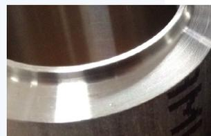
Da Zubehör (Rohrbogen, T-Stücke, Flansche etc.) normalerweise in V-Form vorbereitet werden, sind viele Schweißnähte als V-J-Kombination auszuführen, die schwieriger zu schweißen ist. Die Qualität der Zubehöerteile ist beim Orbitalschweißen auch ein sehr wichtiges Kriterium, das es zu berücksichtigen gilt.
