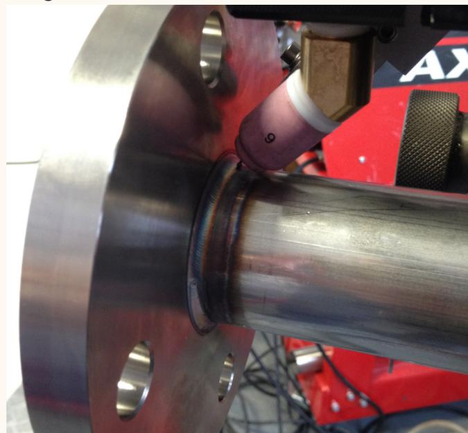
Diese Maschinen, die die Standardmaschinengestelle verwenden, die auch für das Trennen und Anfasen eingesetzt werden, bieten den Vorteil, dass sie robust und einfach zu verwenden sind. Daher ist die Produktlinie SX vor allem für einen Einsatz in einer Werkstatt oder auf einer Baustelle für die Vorfertigung bestimmt.
