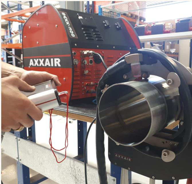
Insbesondere auf die Achskarte, mit der die auf den Schweißköpfen verwendeten Motoren gesteuert werden, wurde bei der Entwicklung besonderes Augenmerk gelegt, um unterschiedliche Motoren und Zusatzfunktionen steuern zu können: Gleichstrommotoren, bürstenlose Motoren, Schrittmotoren, aber auch Drehgeber und Geschwindigkeitsmesser.
