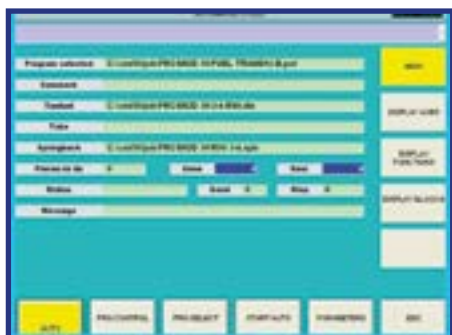
Menù automatico: permette la produzione di parti in automatico, la selezione di un programma (con l'ausilio grafico), la visualizzazione delle posizioni degli assi, ecc.
