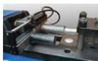
Sistema automatico cambio punzone a due posizioni Automatic two-position punch change system
