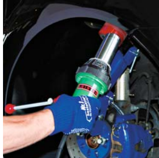
Urychlení schnutí laku, barvy a tmelu pomocí přístroje ELECTRON.
