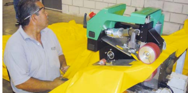
Svařování modifikované technické tkaniny stacionárním automatem COSTA.
