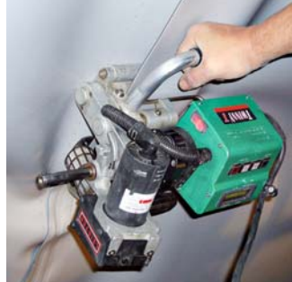
TWINNY T s praktickou příčnou rukojetí při svařování nad hlavou v tunelu.
