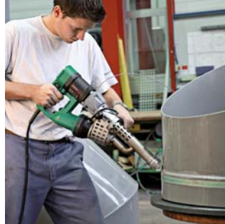
Přístroj FUSION 3C při výrobě nádrží.
