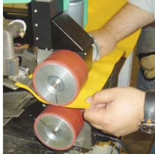
Vyměnitelná silikonová kola pro tenké materiály.
