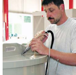
Dmychadlo ROBUST slouží jako zdroj vzduchu pro ruční přístroj WELDING PEN.
