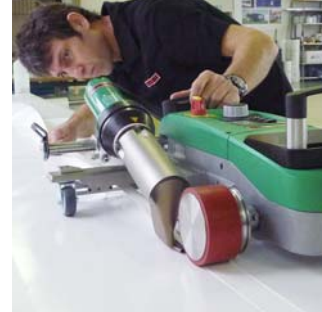
Souprava pro snadné svařování lemu s nebo bez šňůry.
