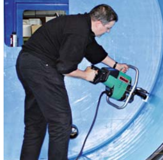
WELDPLAST S6 lze jednoduše ovládat pomocí praktického kruhového držadla.
