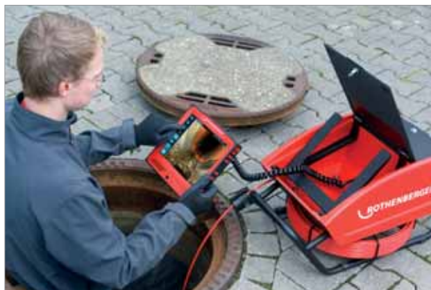
ROCAM® 4 odnímateľná ovládacia jednotka
