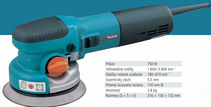
BO6040J s obmedzovačom rozbehového prúdu elektronická excentrická brúska
